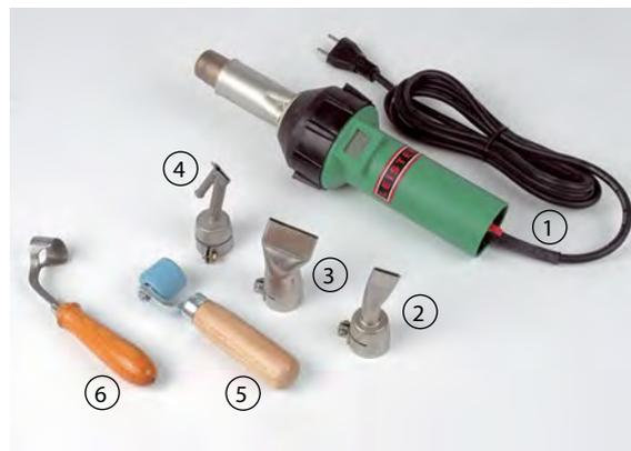
Fig. 4/103: Outillage pour souder lés synthétiques; appareil de soudage à air chaud (1), buse de soudage 20 mm (2), idem 40 mm (3), buse spéciale pour cordon de soudage (4), roulette de pression (5), couteau à chanfreiner (6)
