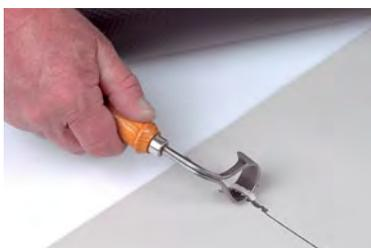
Fig. 4/102: Rabetage du joint de recouvrement avec un couteau à chanfreiner
