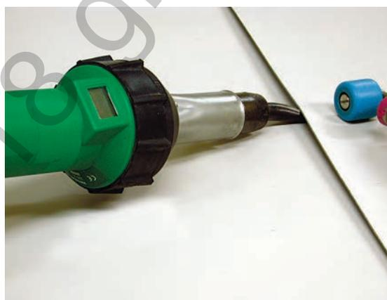
Fig. 4/1002: Soudure d'une bâche en matière synthétique
