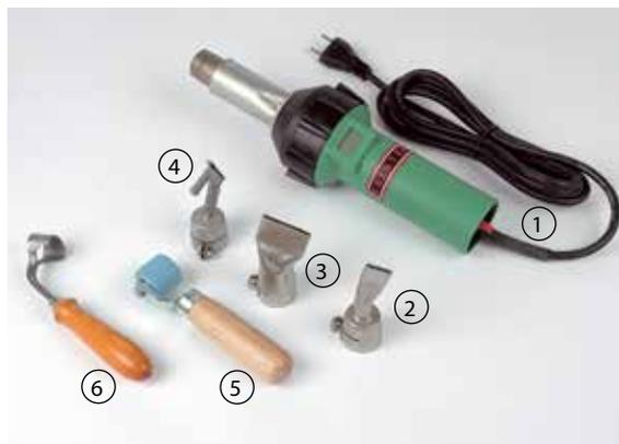
Abb. 4/104: Geräte zum Verschweissen von Kunststoffdichtungsbahnen; Handschweißgerät (1), Schweißdüse 20 mm (2), Schweißdüse 40 mm (3), Spezialdüse für Schweißschnur (4), Andrückrolle (5), Kantenmesser (6)
